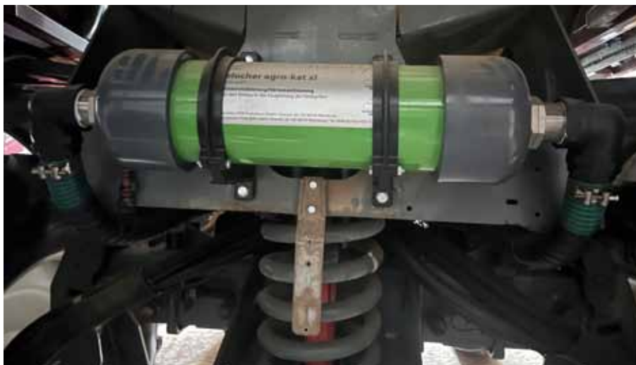
Rys. 3. Urządzenie agro-kat, którego zadaniem jest optymalizacja twardości i odczynu wody (Foto: M. Łukomski)
