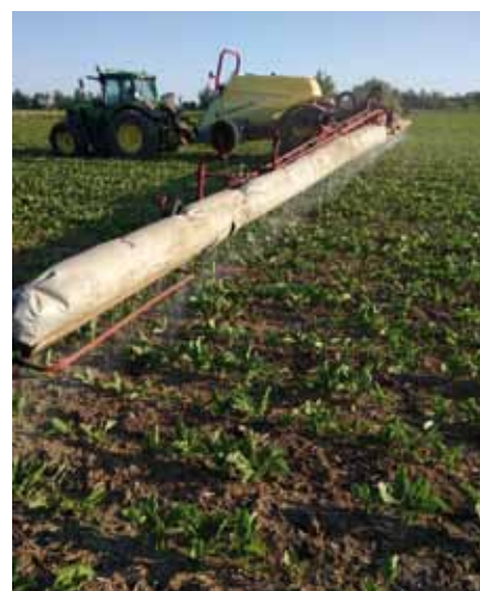
Rys. 1. Opryskiwacz używany w gospodarstwie z rękawem ze zmiennym strumieniem powietrza (Foto: M. Łukomski)
