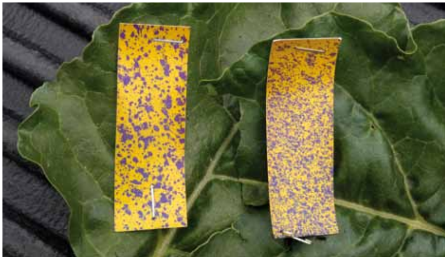
Rys. 6. Porównanie pokrycia powierzchni poprzez zastosowanie dwóch różnych rozpylaczy (Foto: M. Łukomski)
