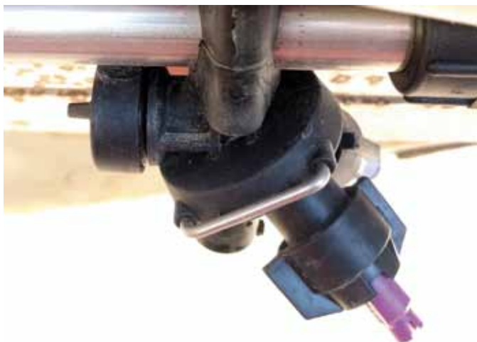
Rys. 4. Rozpylaczce wymieniane na nowe przed każdym sezonem (Foto: M. Łukomski)
