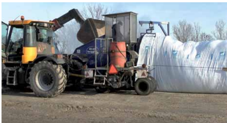
Rys. 1. Proces zakiszania wysłodków z wykorzystaniem profesjonalnego sprzętu (Foto: Sz. Dziuba)
