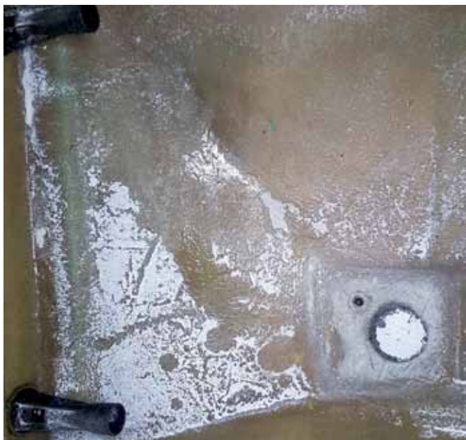
Rys. 2. Osad powstały w wyniku pozostawienia cieczy roboczej. Jeśli zaschnął wymaga w pierwszej kolejności namoczenia. Wypełnij opryskiwacz wodą, uruchom na chwilę i pozostaw do kolejnego dnia (Foto: dr Stanisław Świtek)
