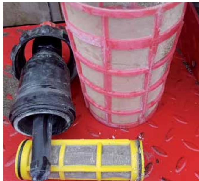
Rys. 6, 7. Należy dokładnie oczyścić osady z filtrów, dysz, zbiornika. Elementy, które można zdemontować powinny zostać rozmontowane do mycia (Foto: dr Stanisław Świtek)
