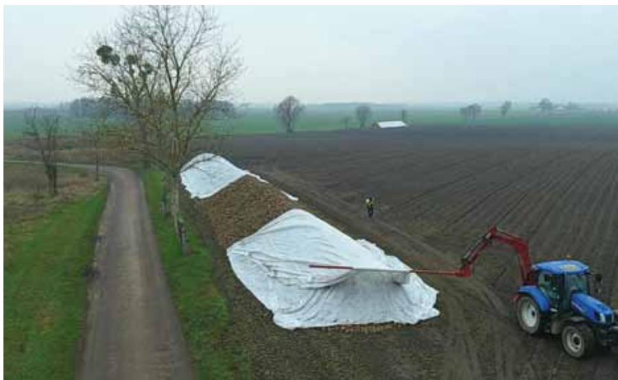
Mechaniczne okrywanie/odkrywanie przyzmy buraków usprawnia prace związane z zabezpieczeniem surowca przed niekorzystnymi warunkami atmosferycznymi
