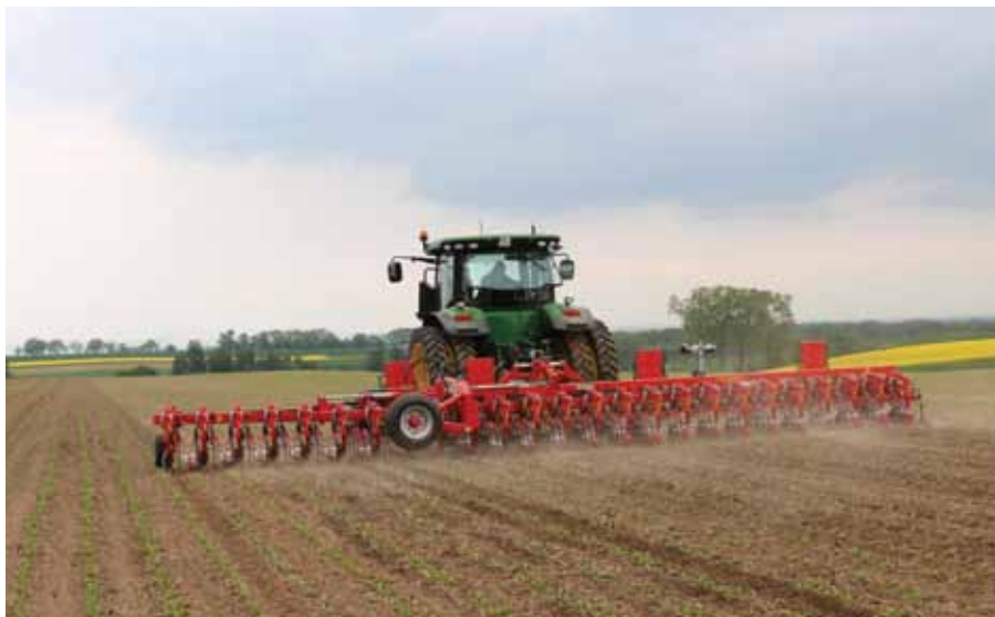
Opielacz napowietrza glebę, niszczy burakochwasty w międzyrzędziach i wspomaga chemiczną walkę z chwastami
